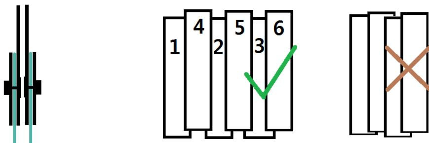
3. Die Streifen dürfen nicht den Boden berühren! Kürzen Sie die Streifen mit einem Cuttermesser so, dass die Marbex Streifen ca. 2 bis 3 cm über dem Boden hängen, damit Gabelstapler oder Hubwagen keine Streifen abreißen können.
