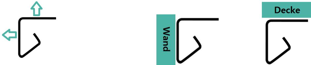
2. Die Klemmbleche an den Marbex Streifen müssen mit der langen Seite aneinander liegen. Die Streifen wie im Beispiel einhängen, erst 1, dann 2, dann 3 anschließend erst Streifen 4, 5 und 6 usw.. Nur die langen Bleche berühren sich:
